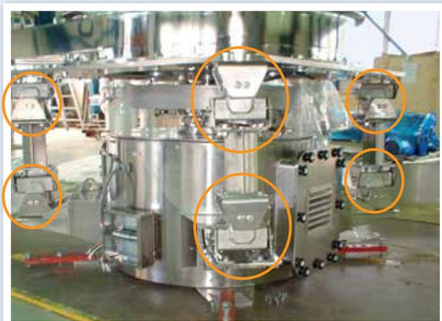
Plansichter-Siebmaschine für Pharmaprodukte auf AK-I 40 Kreuzgelenken
