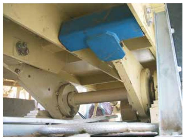
Die standardisierten ROSTA-Schubstangenköpfe ST 80 sind ausgelegt für die Übertragung einer maximalen Beschleunigungskraft von 27'000 N. Beim Antrieb von z.B. grossen Beschickungsbunkern oder sehr langen Holzförderrinnen reicht diese Übertragungskapazität oft nicht aus.
