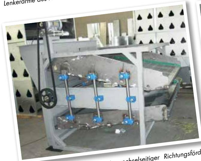
Getreidereinigungsmaschine mit wechselseitiger Richtungsförderung an «Boomerang»-Doppellenker Typ AR 38
