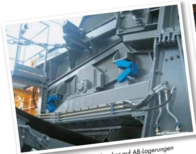
Kreisschwingsieb an mobilem Brecher auf AB-Lagerungen
