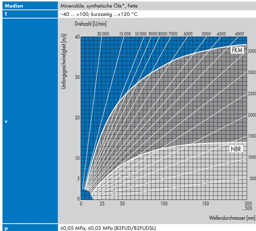
Zulässige Umfangsgeschwindigkeit für Simmerringe aus den Werkstoffen NBR (72 NBR 902) und FKM (75 FKM 585) bei der Abdichtung von Motorenöl SAE 20. Einsatz Simmerring mit SL (Schutzlippe):  $v = \max. 8 \text{ m/s}$ .
